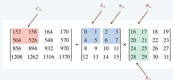
$$C_{11} = A_{11} \times B_{11} + A_{12} \times B_{21} = \begin{bmatrix} 0 & 1 \\ 4 & 5 \end{bmatrix} \times \begin{bmatrix} 16 & 17 \\ 20 & 21 \end{bmatrix} + \begin{bmatrix} 2 & 3 \\ 6 & 7 \end{bmatrix} \times \begin{bmatrix} 24 & 25 \\ 28 & 29 \end{bmatrix} = \begin{bmatrix} 152 & 158 \\ 504 & 526 \end{bmatrix}$$
