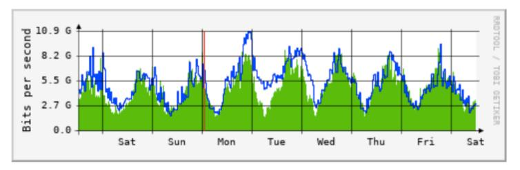
Max In: 9014.1 Mb/s (11.3%) Average In: 4606.7 Mb/s (5.8%) Current In: 3284.8 Mb/s (4.1%) Max Out: 10.9 Gb/s (13.6%) Average Out: 5217.0 Mb/s (6.5%) Current Out: 2952.5 Mb/s (3.7%)
