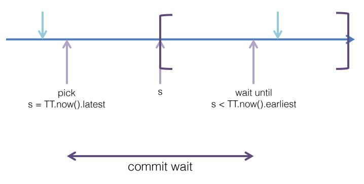
$$\begin{split} s_1 < t_{abs}(e_1^{commit}) \\ t_{abs}(e_1^{commit}) < t_{abs}(e_2^{start}) \\ t_{abs}(e_2^{start}) < t_{abs}(e_2^{server}) \\ t_{abs}(e_2^{server}) < t_{abs}(e_2^{server}) \\ \end{split}$$
