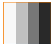
P(x,y) (2 bits per pixel)
