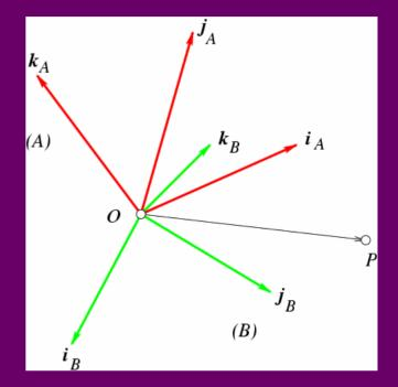
$$\overrightarrow{OP} = \begin{bmatrix} \mathbf{i}_A & \mathbf{j}_A & \mathbf{k}_A \end{bmatrix} \begin{bmatrix} A \\ A \\ A \\ A \\ Z \end{bmatrix} = \begin{bmatrix} \mathbf{i}_B & \mathbf{j}_B & \mathbf{k}_B \end{bmatrix} \begin{bmatrix} B \\ Z \\ B \\ B \\ Z \end{bmatrix}$$
